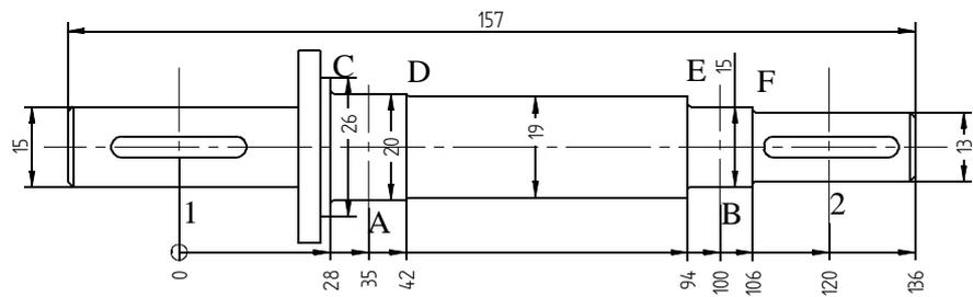
Alle sezioni 1 e 2 dove sono applicati i carichi ed A e B dove sono applicati i vincoli sono state aggiunte le sezioni C, D, E ed F dove si ha una variazione di sezione
