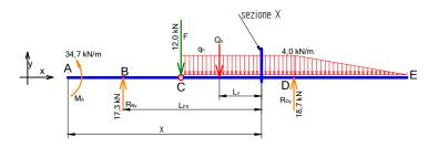
Per il taglio si userà la relazione  $T(x) = \sum_{0}^{x} F_{y} + \sum_{0}^{x} Q_{x}$  quella ustata per il momento è  $M(x) = \sum_{0}^{x} m + \sum_{0}^{x} F_{y} \cdot L_{Fx} + \sum_{0}^{x} Q_{x} \cdot L_{x}$
